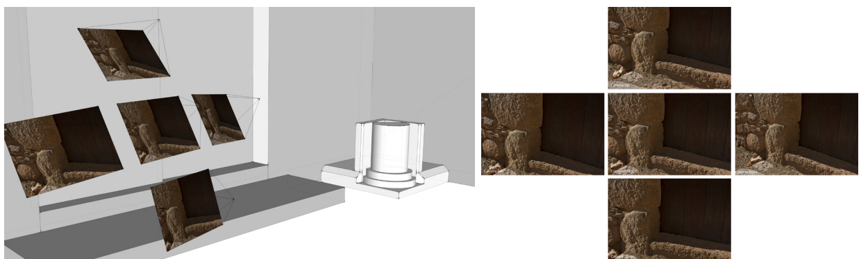
Fig.14 - Prise de vue pour la calibration de la base
