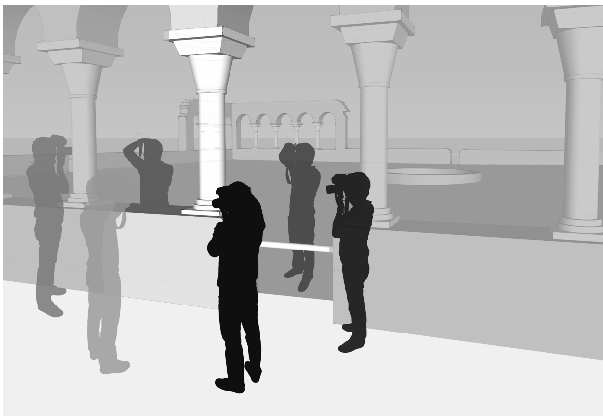
Fig.8 - Exemple d'acquisition convergente autour de la colonne
