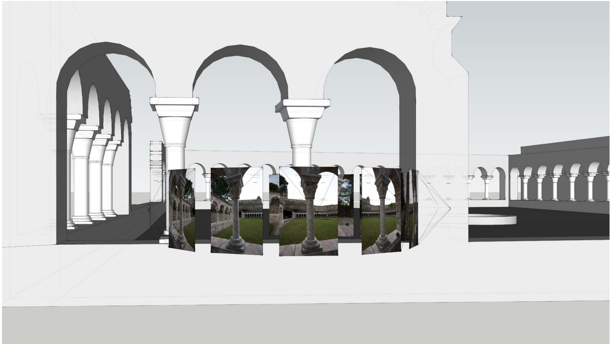
Fig.15 - Pise de vue convergente pour l'orientation globale d'une colonne
