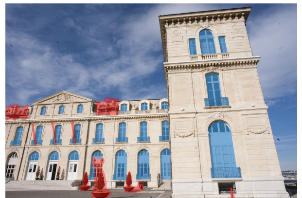
Fig.6- Les différents obstacles: en rouge les éléments qui obstruent la façade, en bleu les éléments qui perturbent les calculs de corrélation.
