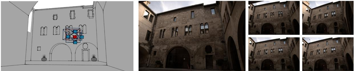
Fig.20 - Schéma d'acquisition et prises de vue de la corrélation.
