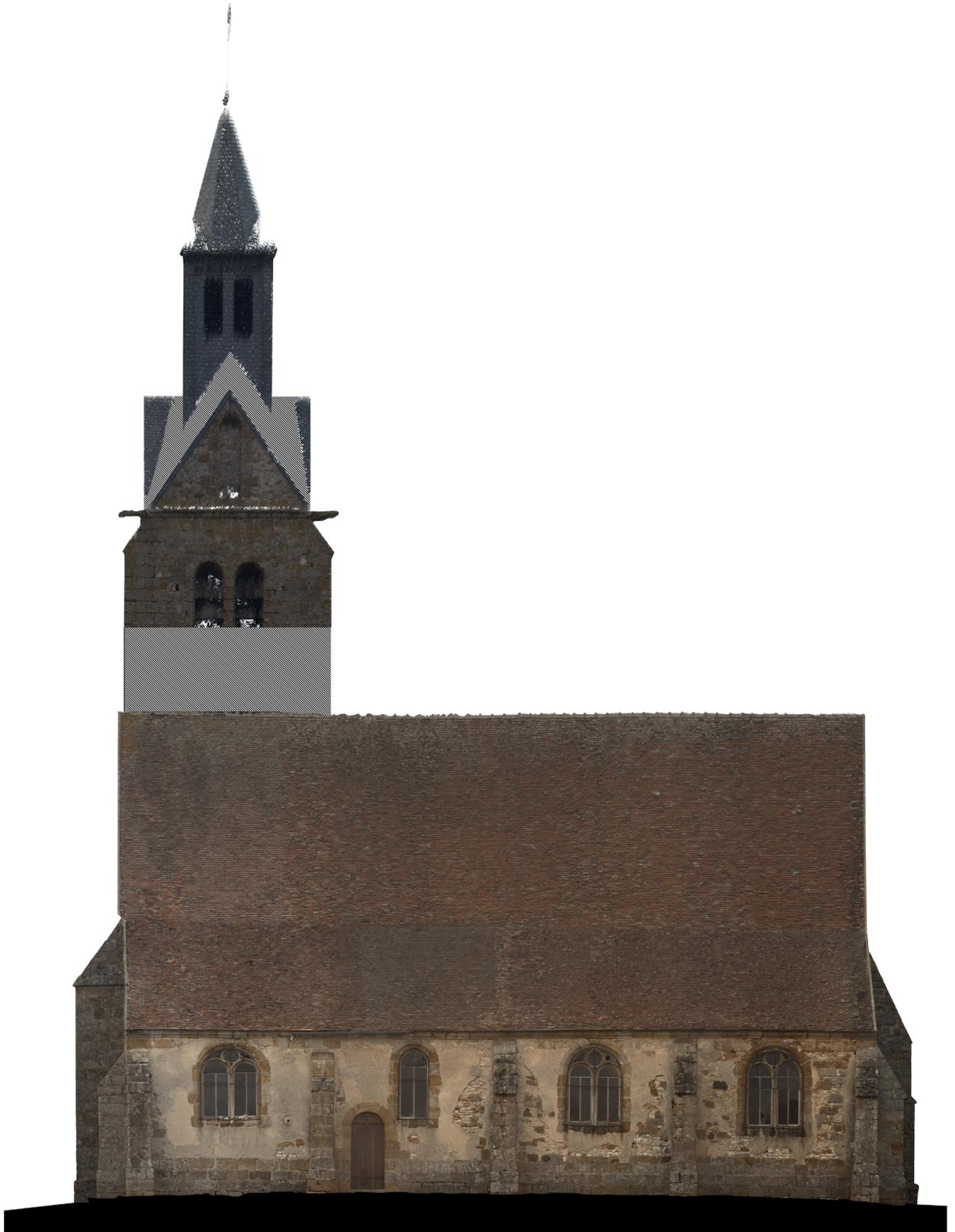
*Fig.21- Exemple d'orthophotographie extraite du nuage de points: la façade sud*
